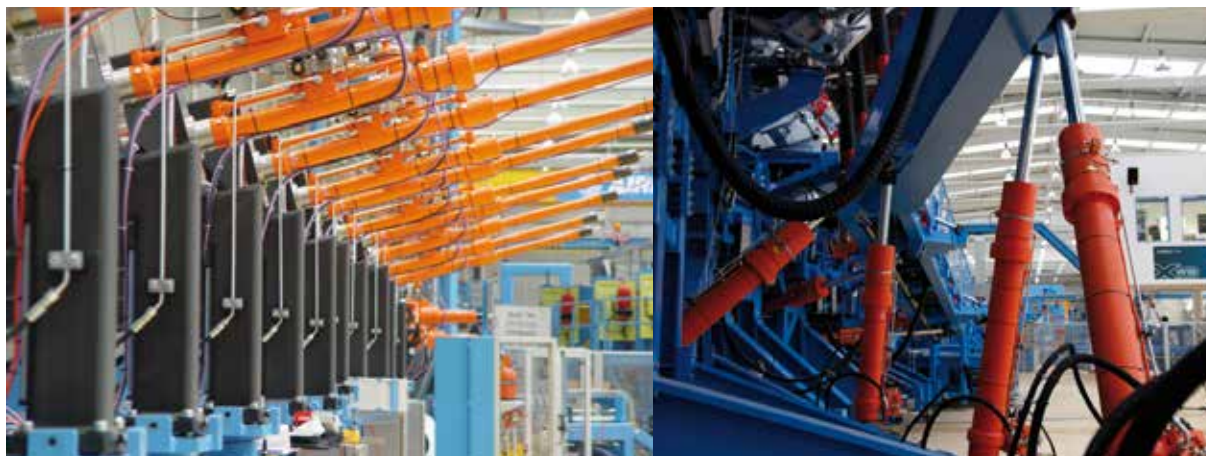
6 | Slat-Station mit 14 Hydraulik-Zylindern von Hänchen 7 | Hydraulik-Zylinder des Hexapod mit angeflanschter Ratio-Clamp®
