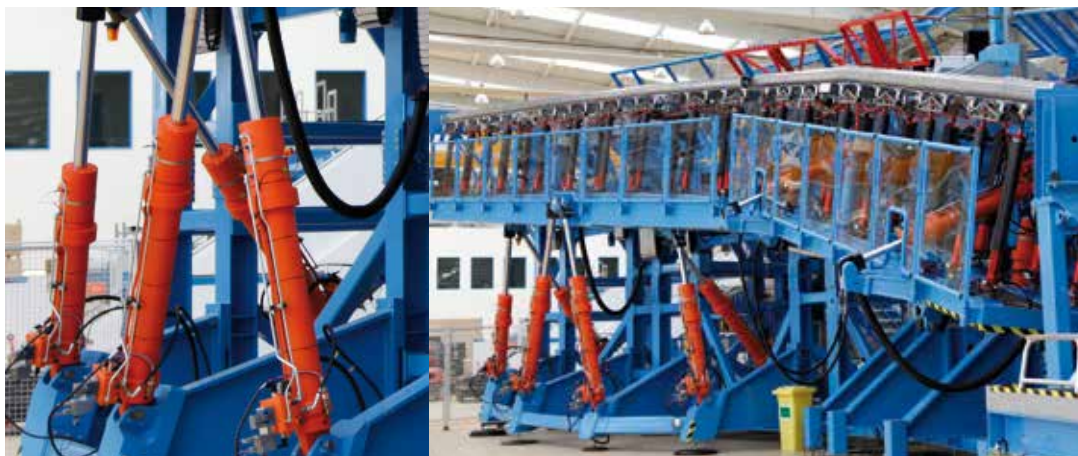
1 | Tragflächen-Prüfstand zum Simulieren des Luftstroms
