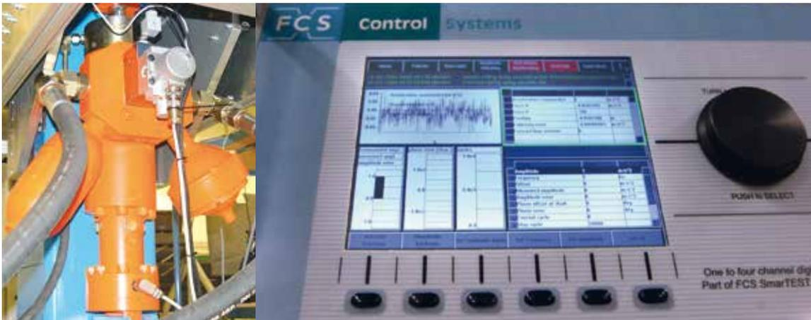
3 | Hydraulikzylinder mit Blasen- und Membranspeicher im FCS-Teststand.
