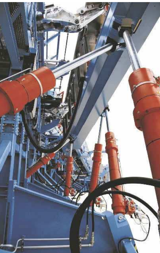
Während des Prüfprozesses schützt die hydraulische Klemmung hochdynamische Test-Aktuatoren durch sicheres Fixieren. (Bilder: Herbert Hächchen)
