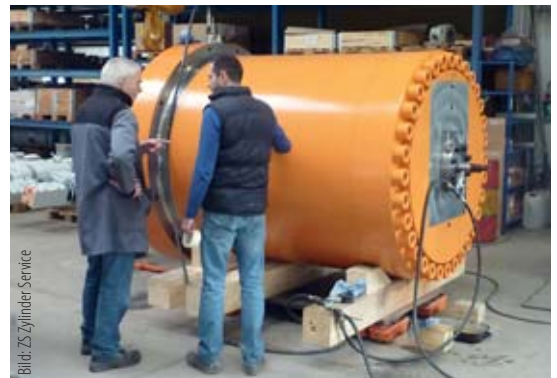
Spezialfertigung: Kolbendurchmesser bis zu 10 Meter haben die Sonderzylinder von ZS Zylinder Service. Das Unternehmen registriert eine verstärkte Nachfrage nach Umweltverträglichkeit.
