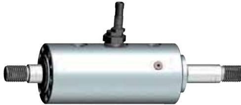
**Die Ratio-Clamp packt zu und fixiert die Kolbenstange dort, wo sie sich gerade befindet. Ohne extra Kräfte zu mobilisieren (ohne zusätzliche Energiezufuhr) und solange, bis eine Funktionsstörung gelöst ist.**
