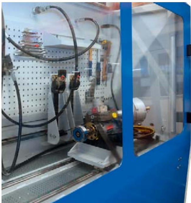
Die Prüfzelle für hydraulische Produkte ist softwaregesteuert. Jeder Prüfvorgang wird durch einen Barcode auf dem Prüfling initiiert. Dann beginnt der automatische Prüfvorgang.
