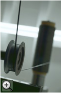
Das Ausgangsmaterial für H-CFK: Eine Kohlefaser, bestehend aus rund 12000 Einzelfäden. (Bild: Hänchen)
