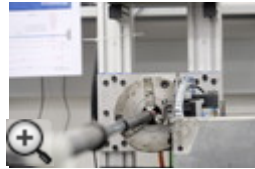
Die Wickelmaschine zur Fertigung runder H-CFK-Bauteile wurde von Hänchen selbst entwickelt. (Bild: Hänchen)
