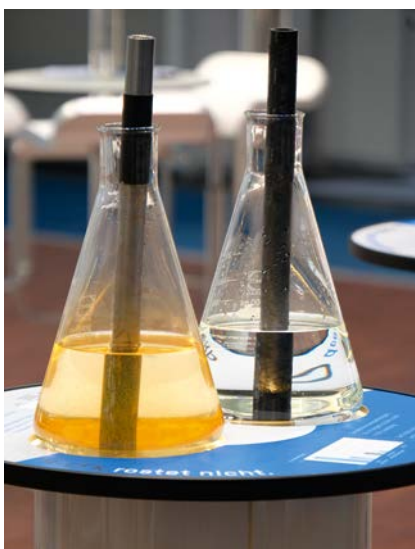
Der Vergleich zeigt: Bauteile aus H-CFK sind im Gegensatz zu solchen aus Stahl rostfrei (© Herbert Hänchen GmbH)
