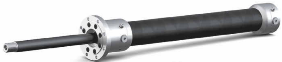
Krafteinleitende Elemente, wie das Gewinde am Ende einer Kolbenstange, werden bei der Produktion fest in die H-CFK-Kolbenstange eingebunden. So entsteht eine hochfeste Verbindung.
