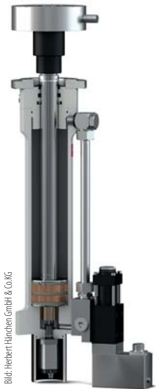
Hydraulikzylinder mit Wegmesssystem und Kraftaufnehmer für dynamische Anwendungen bis 7 Hz.
