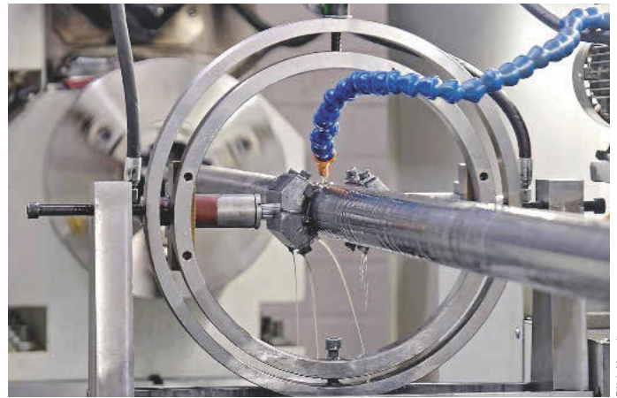
Alle Kolbenstangen und Zylinderrohre werden bei Hänchen gehont
