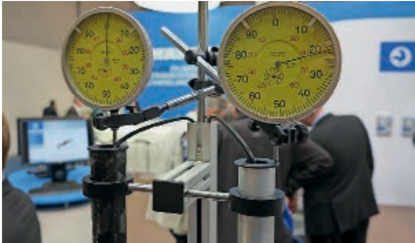
Wärmeausdehnung gegen Null: Der Vergleich H-CFK zu Aluminium-Hydraulikzylinder zeigt, dass sich der H-CFK-Zylinder im Gegensatz zum Aluminiumzylinder bei Erwärmung nicht ausdehnt.
