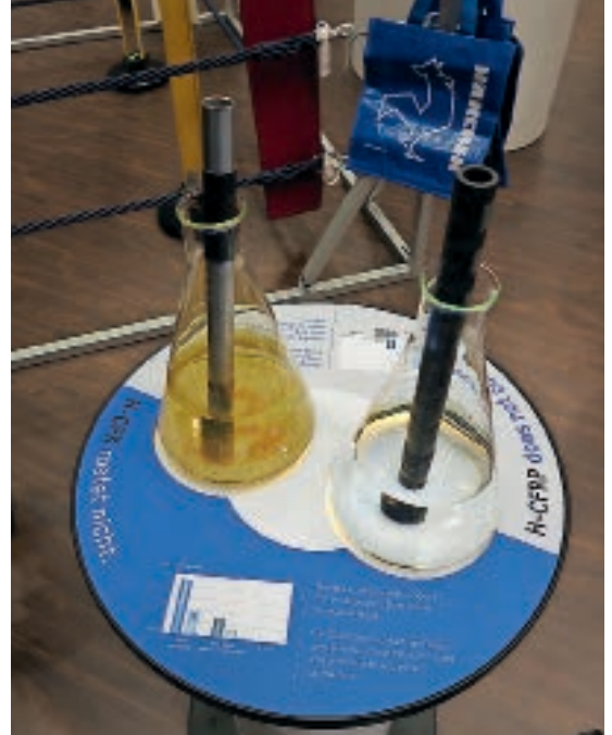
Rostfrei: H-CFK rostet nicht und wurde bereits mit zahlreichen Hydraulikfluids auf Beständigkeit getestet.
