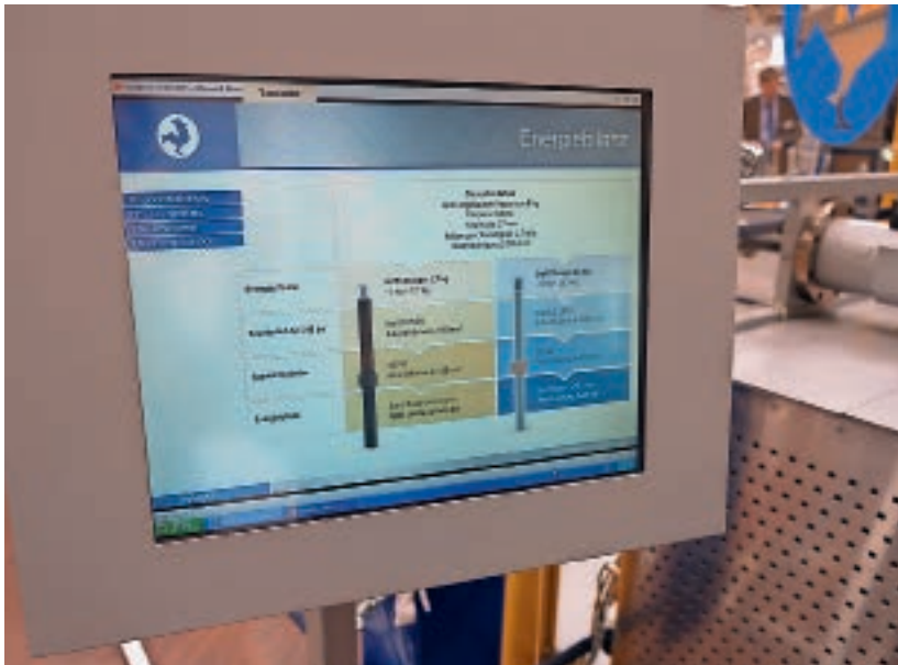
Die Energieeffizienz einer H-CFK-Kolben-Zylinder-Einheit zeigt sich in der Steuerung: Die H-CFK Zylinder benötigen lediglich 14 kW hydraulische Leistung, P'. Für Stahl-Kolben-Zylinder-Einheit ist viel mehr Leistung notwendig, nämlich 25 kW. Foto: Erik Schäfer
