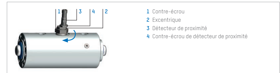
Illustration 12 : Régler le détecteur de proximité sur verrouillé
